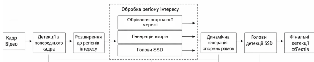
Рис. 1. Запропонована структура динамічного SSD з урахуванням регіонів інтересу. Виявлення з попереднього кадру визначають області інтересу, які обробляються незалежно з адаптивною глибиною згорткової мережі та генерацією специфічних для регіону якорів.
