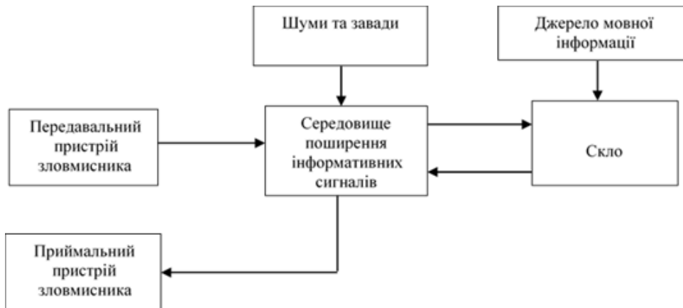
Рис. 1. Узагальнена структурна схема акусто-електричного каналу витоку інформації за рахунок ВЧ-нав'язування
