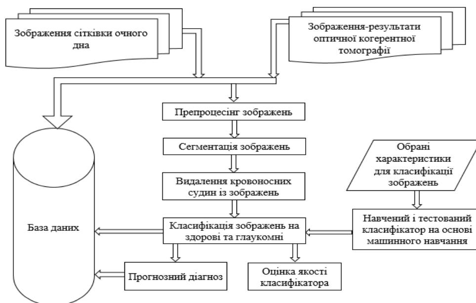
Рис. 1. Структура інформаційної технології діагностування та прогнозування глаукоми
