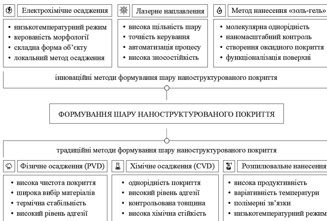
Рис. 2. Структурно-функціональна характеристика методів синтезу наноструктурованого покриття
