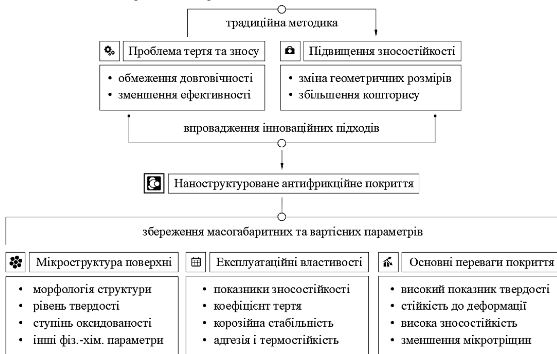
Рис. 1. Логіко-функціональна діаграма застосування наноструктурованого антифрикційного покриття з метою підвищення експлуатаційних характеристик матеріалів
