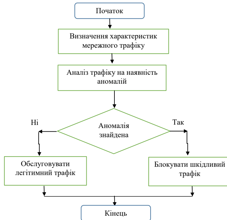
Рис. 2. Алгоритм виявлення аномалій Flood-трафіку DDoS-атак
