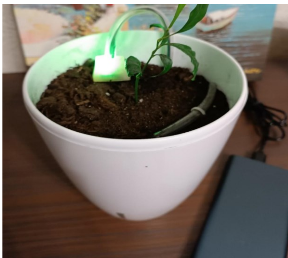
Рис. 2. Експериментальний зразок системи з підключеними сенсорами та RGB LED-індикацією
