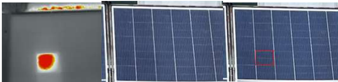
Рис. 8. Зображення з IR, RGB камер та з виходу програмного модуля на базі YOLOv8
