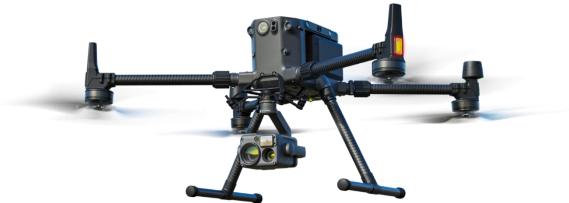
Рис. 1. Безпілотний літальний апарат DJI Matrice 300 RTK з встановленим мультисенсорним підвісом DJI Zenmuse H20T (RGB камера, тепловізор, лазерний далекомір)
