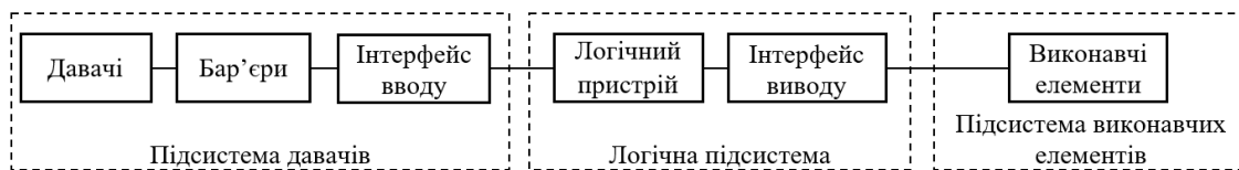
Рис. 2. Узагальнена структурна блок-схема контуру безпеки
