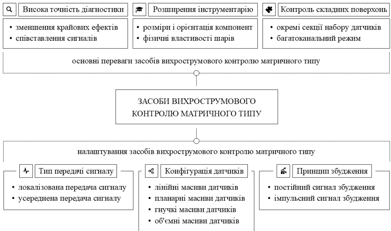
Рис. 2. Схема організації засобів автоматизованого вихрострумового контролю матричного типу
