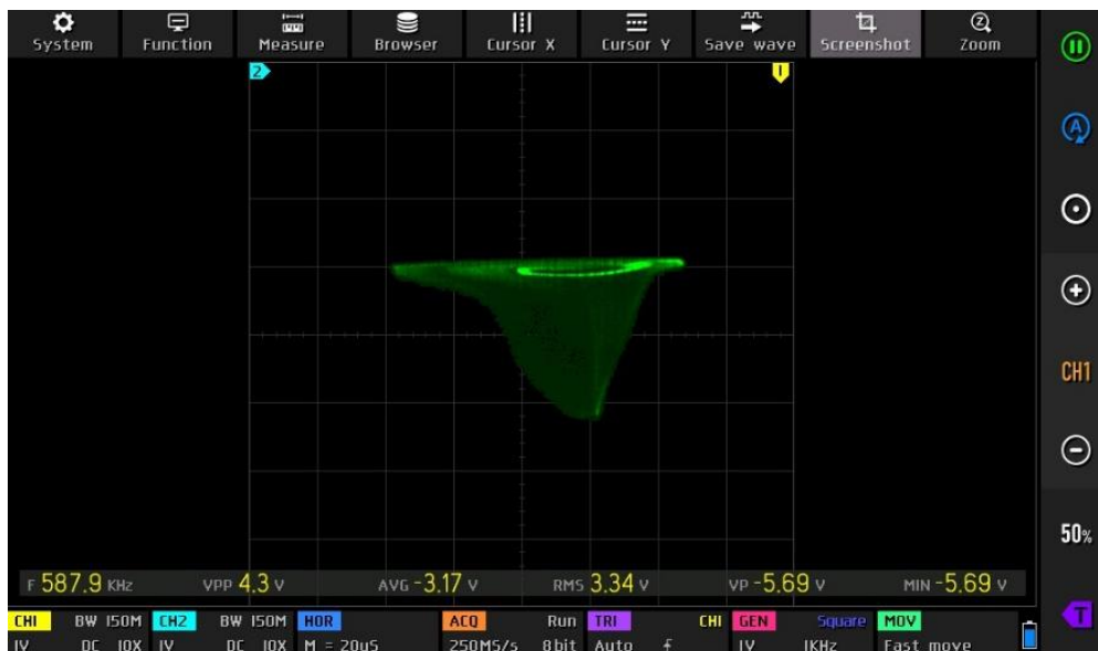
Рис.6. Фазовий портрет генератора детермінованого хаосу на основі біполярно-польової транзисторної структури у площині динамічних змінних
