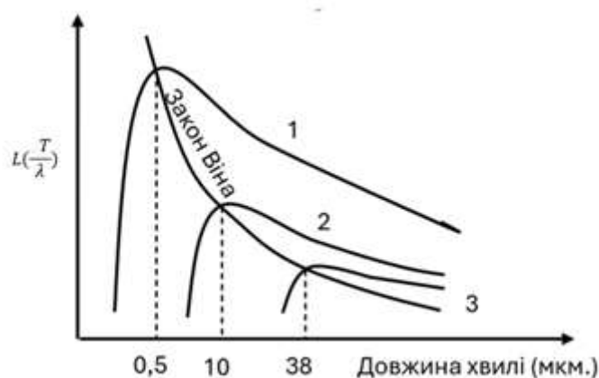
Рис.7 Спектральний розподіл густини потоку поверхні випромінювання різних джерел: 1- Сонце, T \approx 6000 \text{ К} ; 2 – випромінювання абсолютно чорного тіла при температурі навколишнього середовища, T \approx 290 \text{ К} ; 3 – випромінювання абсолютно чорного тіла при температурі T = 77 \text{ К} . [2]
