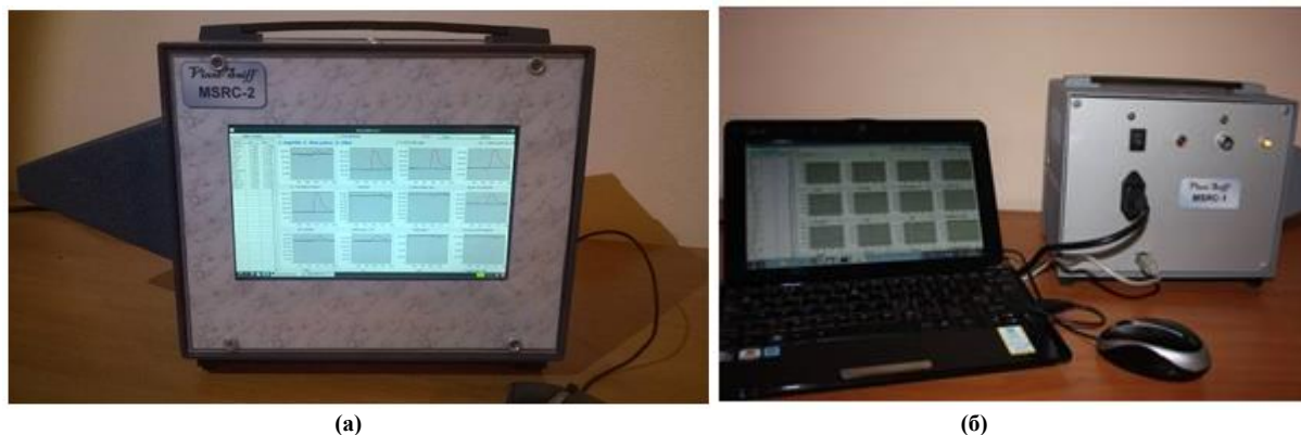
Рис. 1. Багатоканальний пристрій розпізнавання запахів і концентрацій газів у реальному часі MSRC-2: зовнішній вигляд (а) [11, стор. 80] і підключення його до ноутбука (б) [12]
