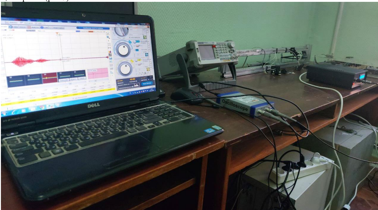
Рис.2. Експериментальний стенд визначення параметрів ультразвукових хвиль в хвилеводі із застосуванням розробленого цифрового генератора
