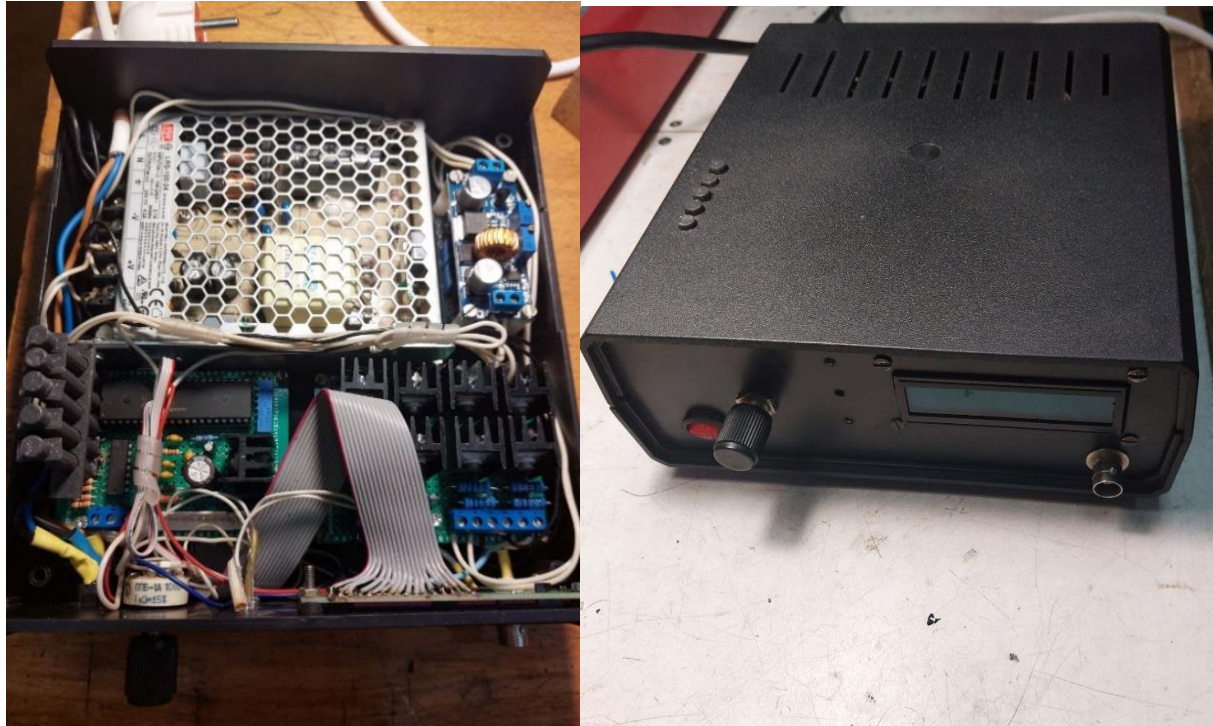
Рис.3. Експериментальний цифровий генератор на МК PIC16F887
