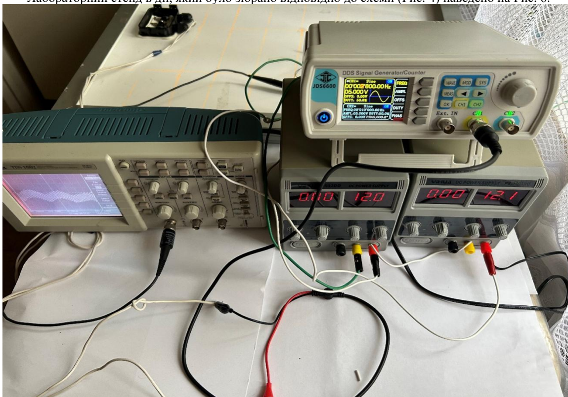
Рис. 6. Лабораторний стенд з безконтактного вимірювання шунтового опору сонячних елементів в дії: на задньому плані фото видно тильну сторону сонячної панелі, самі антени датчики в кадрі відсутні
