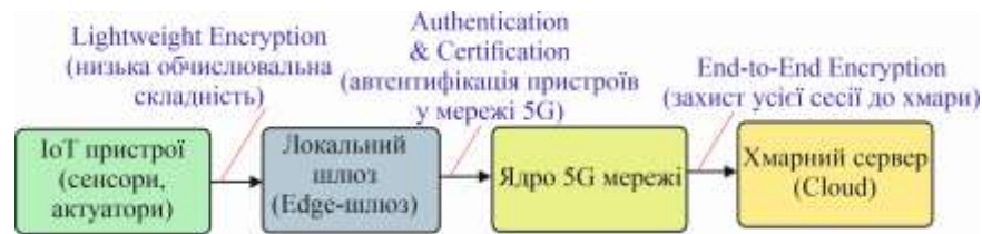
Рис. 2. Блок-схема архітектури захищеної взаємодії компонентів IoT у мережі 5G
