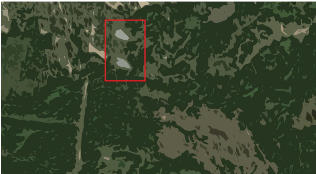
Рис.7. Приклад сегментації зображення за допомогою методу Сanny(). Виявлення контуру лісової пожежі
