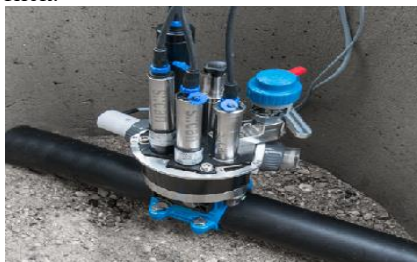
Рис. 5. Pipe scan - система датчиків для контролю якості питної води в трубах під тиском
