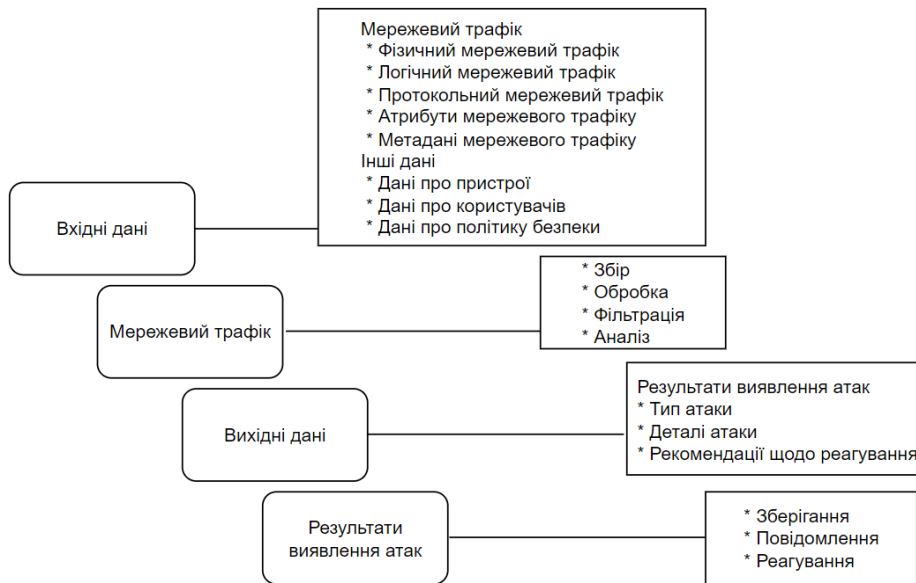
Рис. 4 Діаграма потоку даних системи для виявлення шкідливих пакетів
