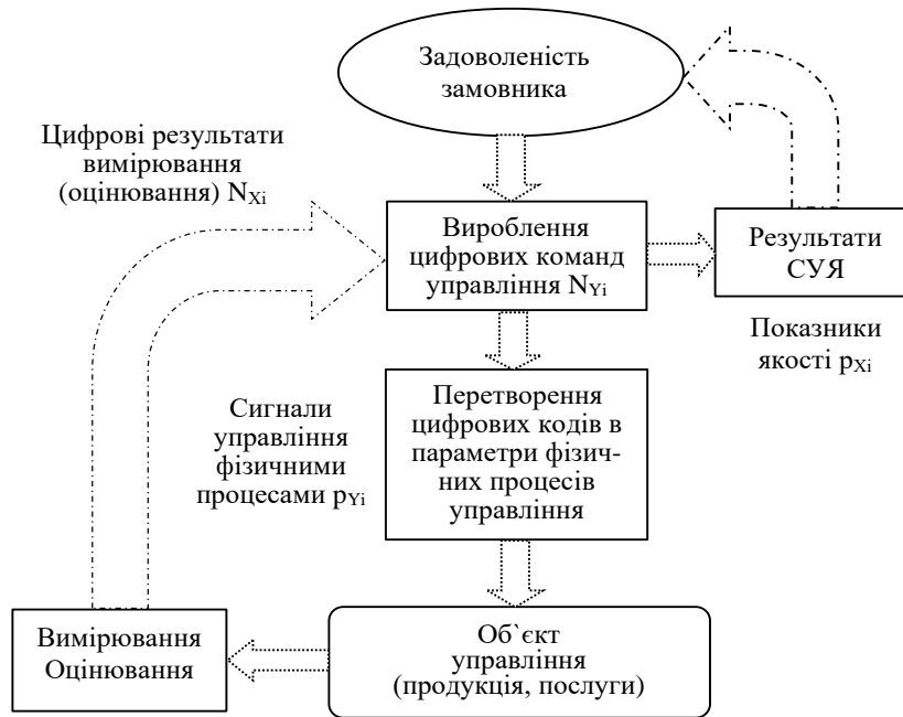
Рис. 3. Структура цифрової системи управління в СУЯ
