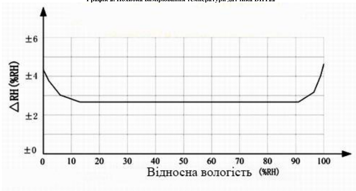
Графік 3. Похибка вимірювання відносної вологості датчика DHT22
